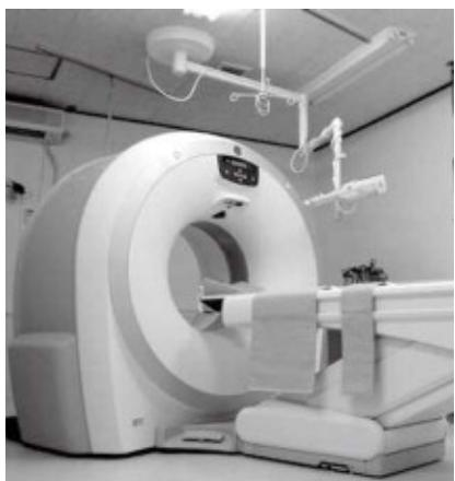
南台病院では、全身コンピュータ断層撮影装置CTを7月に新機種に更新しました。撮影機構部がコンパクトになり撮影時の圧迫感を和らげ、撮影時の細やかな位置決めを不要にして、患者様の負担軽減を図り、高齢者をはじめとする撮影条件の厳しい患者様にも最適化したものとなりました。撮影時間の被曝量も低減して、一度の検査で様々な角度から高精細かつスピーディーな広範囲撮影を可能にする優れた新機能も有しています。画像処理も、高速実用性を備え、その場で高精細三次元解析画像を構築できます。当院での診断はもとより、他院からの撮影依頼にも対応しておりますのでどうぞご利用下さい。(放射線科長 町田)
